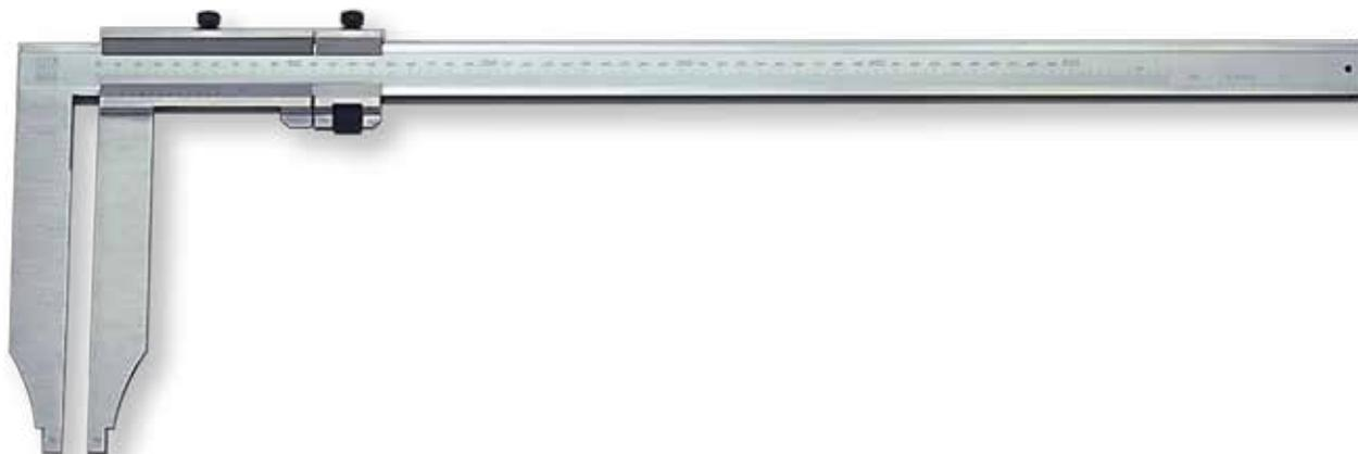
**Calibro** in acciaio inox temprato con corsoio monoblocco e **becchi lunghi**. Lettura della scala cromata. Graduazione di precisione incisa, di facile lettura e durevole nel tempo, leggermente arretrata protetta da due spallamenti per la guida del corsoio. Bloccaggio a vite con avanzamento micrometrico, superfici di contatto lappate. Fermo corsoio a fine asta. Dotato di numero di matricola. Costruito secondo norma DIN 862. Fornito in astuccio.
